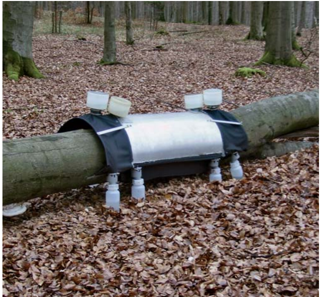
Ein Ekλεκtor an einem am Boden aufliegenden Baumstamm. Mit diesem Fallentyp fängt man Tiere, die am Stamm entlang laufen oder aus der Rinde schlüpfen.
